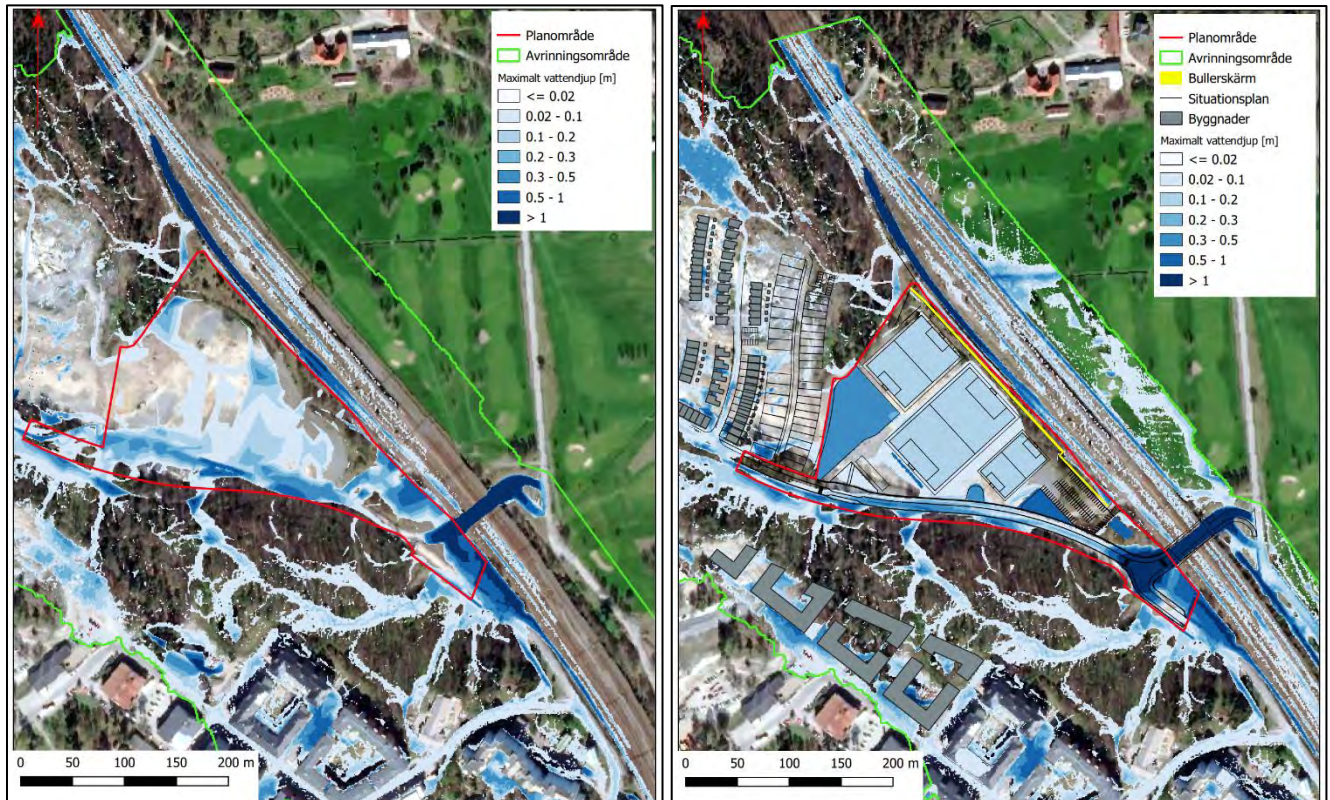
Figur 16 Skyfallskarteringar för ett 100 års regn med klimatfaktor 1,25 i dagens situation (till vänster) och efter ombyggnation med föreslagna åtgärder (till höger). Båda bilderna visar scenariet utan avdrag för ledningsnätet.
